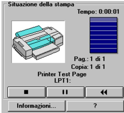
Il Despooler divide ciascuna pagina in una o più bande orizzontali per sottoporle all'elaborazione. Quando il Despooler invia una banda alla stampante, passa a elaborare la successiva. L'avanzamento del lavoro di elaborazione su ciascuna banda e del lavoro nel complesso è mostrato nella finestra di stato della stampante che costituisce l'interfaccia grafica del Despooler. In questa finestra potete verificare quale pagina è in corso di stampa.
